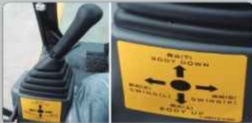
덤프 회전 및 조작 일체형 레버 (사용자 중심의 작동방식)
